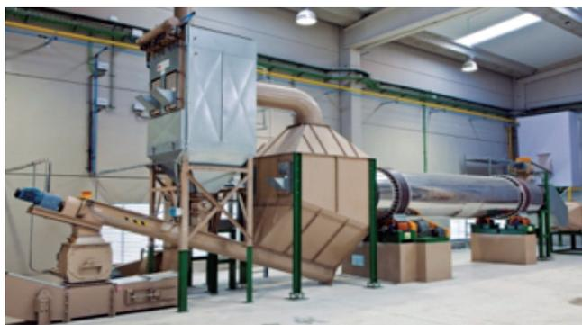
La Planta de Peletizado tiene una Capacidad de producción de entre 200 – 500 Kg/h, en función del material y dispone de:
