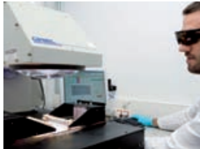
▼ Caracterización de células FV. PV cell characterization.
